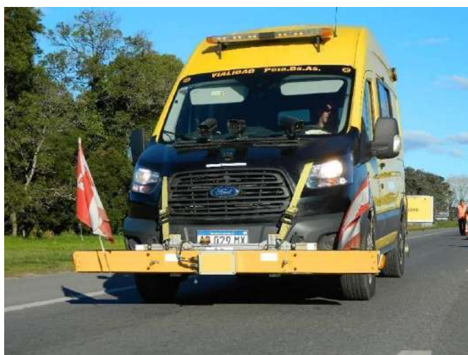
EQUIPO TPL MONTADO SOBRE VEHÍCULO
