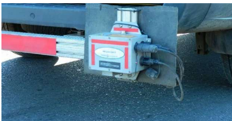
RUGOSÍMETRO LÁSER MONTADO SOBRE EQUIPO MULTIFUNCIÓN
