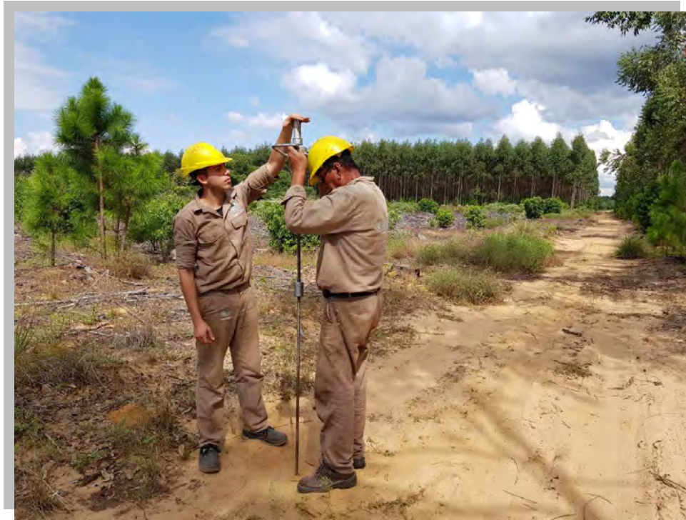
Fotografía N° 3: Ejecución de DCP- C4
