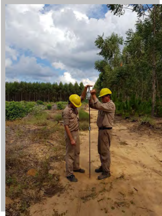
Fotografía N° 1: Ejecución de DCP- C1
