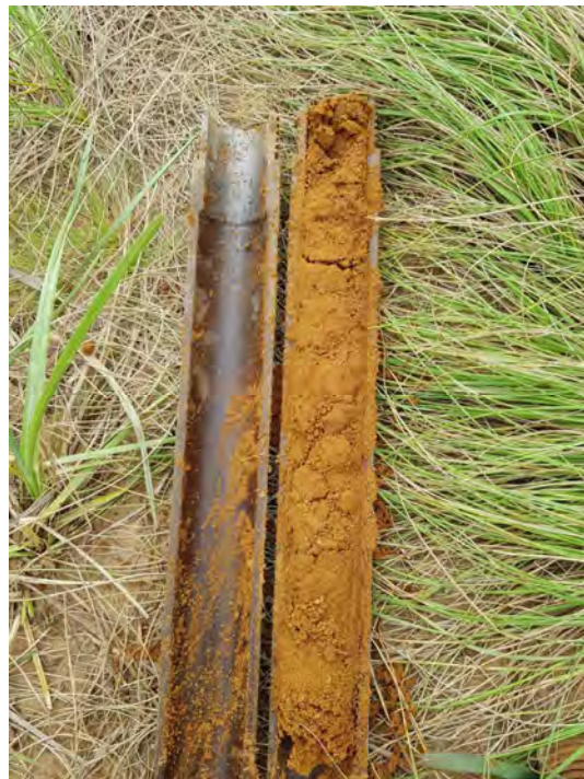
Fotografía N° 10: Extracción de muestra arena mal graduada SP –sacamuestra Terzaghi
