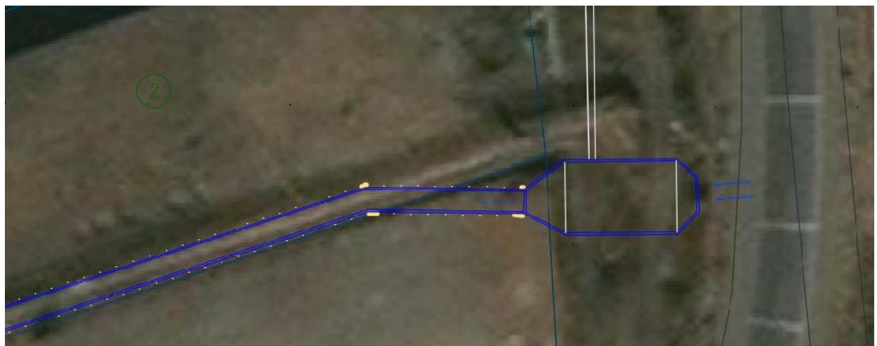
Ilustración 23: Obras de Vinculación Alcantarillas N° 4 y 5 (Existentes) con Canal N° 5
