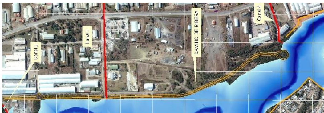
Ilustración 33: Modelación Matemática en que se Aprecia los niveles de Crecida del Río para 50 años de Recurrencia
