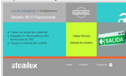
T4: luz emergencia con indicación de “SALIDA” autónoma, permanente, doble faz, lámina gráfica, con lámpara de 8W y autonomía de 5 horas
