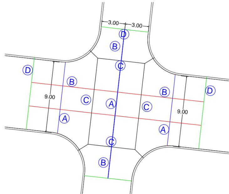
DISEÑO DE JUNTA CON CORDON CUNETA EXISTENTE
