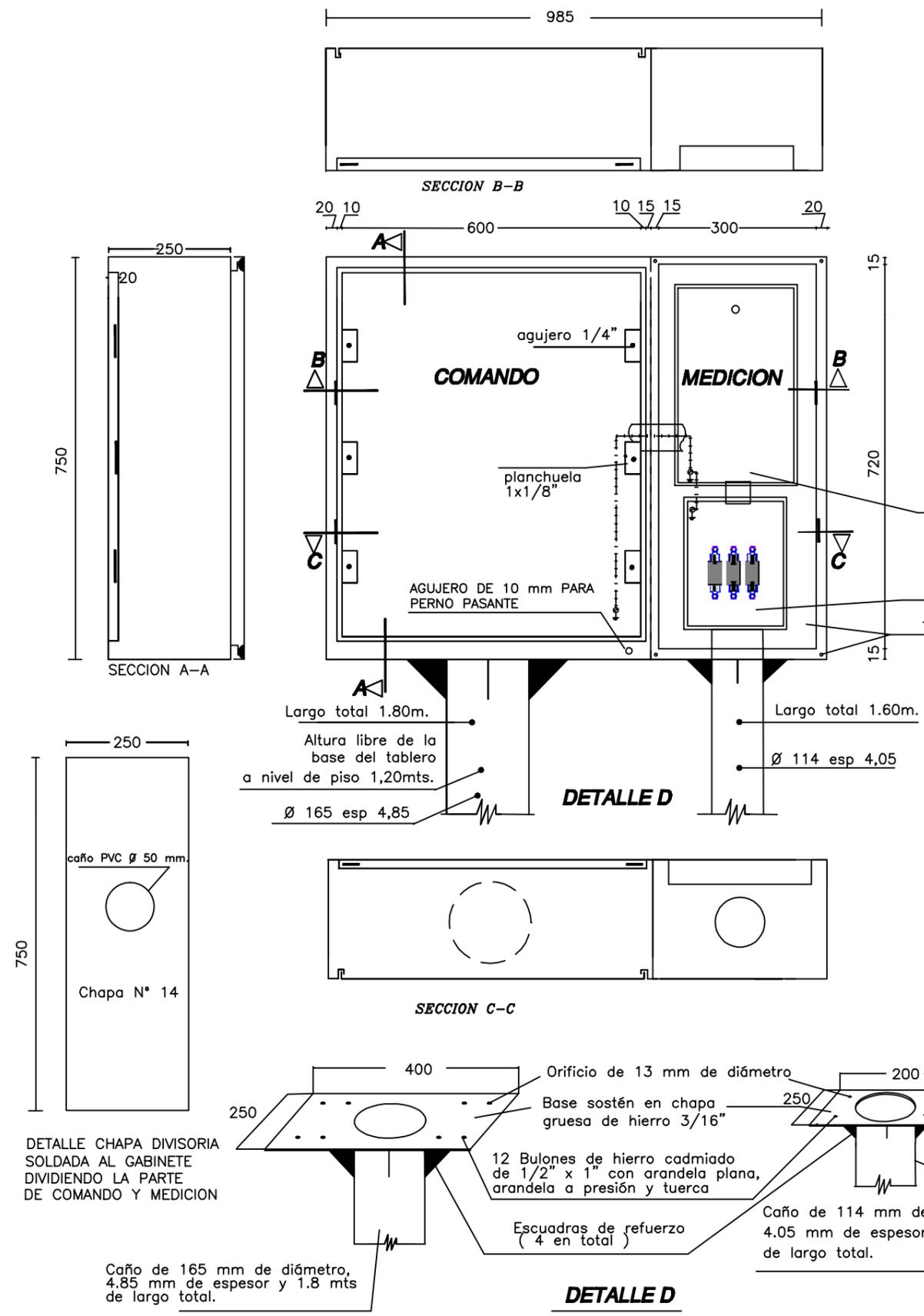
Bandeja para elementos de proteccion y comando
