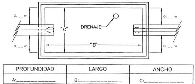
Las paredes se realizan en mampostería de ladrillos con un espesor de 0,15 m revocadas interiormente con mortero de cemento impermeable. Las paredes que contengan los ganchos de tiro se armaran de un espesor de 0,30m
