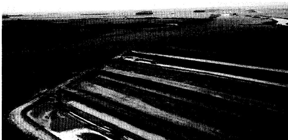
*Recinto para deposito del material proveniente del dragado y de la excavación terrestre – Rio Salado Tramo III – Sector 1*
